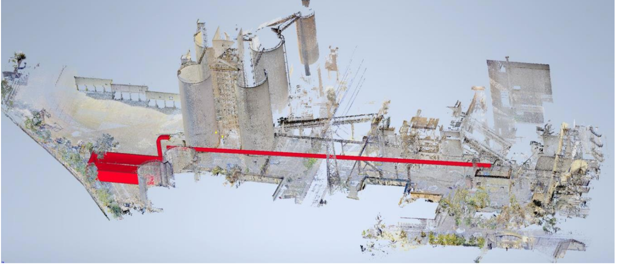
Şekil 4. Döner Fırın (DF#1) ve planlanan ATY besleme sisteminin şematik gösterimi kırmızı ile belirtilmiştir
