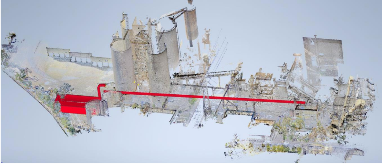
Şekil 4. Döner Fırın 1 (DF#1) ve planlanan ATY besleme sisteminin şematik gösterimi kırmızı ile belirtilmiştir
